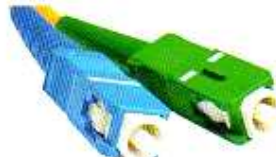
Fibra óptica. Es una fibra de material transparente (vidrio o plástico) por la que se envían los datos en forma de haz de luz, a gran velocidad.
