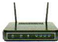
Router. Interconecta diferentes redes de ordenadores, como es el caso de varias LAN. Se utiliza habitualmente para realizar la conexión a Internet.
